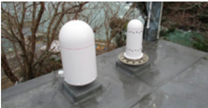
写真：モニタリングステーションに設置している測定器 (左：電離箱 右：NaI)
